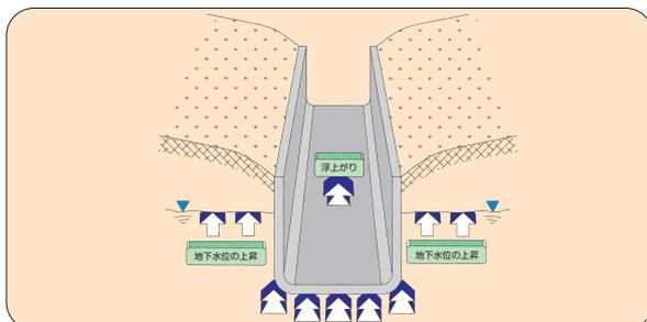
角型U字溝は材質がポリエチレン製であり軽量なことから据付け地盤の強度に対する要求度が低く、設置可能基盤の範囲が広いことが利点です。ただし、慢性的な過湿地や集中豪雨などで地下水位が高くなった場合においては浮力の発生により浮き上がりが発生することがあります。
