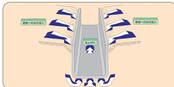
また、角型U字溝設置後の地山すりつけが不良で、埋め戻し面が角型U字溝の縁部より低くなるような箇所では、雨水等がU字溝測部に流入してU字溝を浮き上がらせることがあります。
