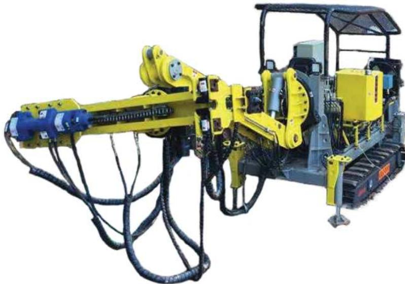
MEERKAT-25Xのはトンネル専用油圧式削孔機である。幅1,400m、高さ2,200mという小型の機械により、あらゆる角度で穴掘りが可能！プロジェクトによって色んなガイドシエルの長さのおかげで2.4m、1.8m、1.2mと0.6mのロッドを使える。電気モーターを使用することで、MEERKAT-25Xは環境に優しい電源で動作します。強い7kWの油圧ドリフターでオペレーターのスリル、環境、エアコンプレッサーの出力と工具の重さにより、Φ36mm(最適切な直径)で10mまでの穴を掘られる。
