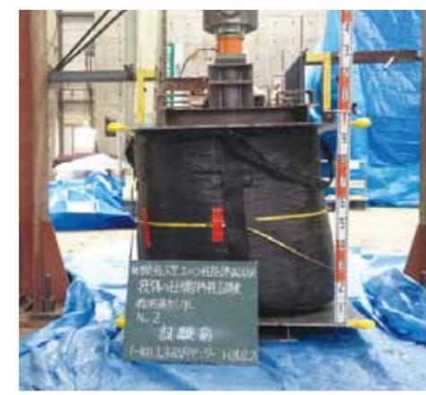
所定の圧力 (200kN) を加えた後に、生地の亀裂・破損等により、中詰め材がこぼれださないことを調べる。
