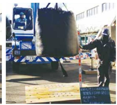
所定の落下回数 (3 回) 後に生地の亀裂・損傷等により、中詰め材がこぼれださないことを調べる。
