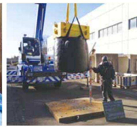
所定の繰返し回数 (10 回) 後に、吊上げ材、生地の亀裂、破損等により、中詰め材がこぼれださないことを調べる。
